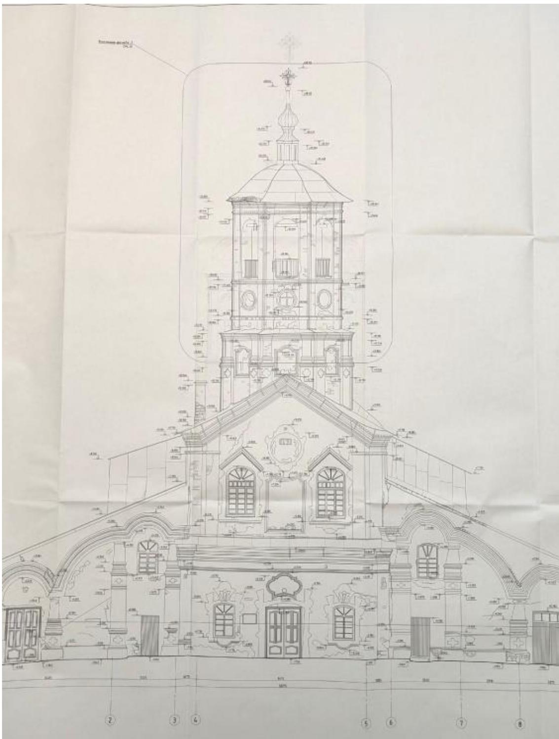
Рис. 6. Лазерное 3D-сканирование фасада
